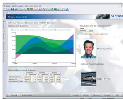
Einstiegsbericht für ein BI-Portal mit allgemeinen KPIs. Zeigt Verkäufe des Monats, Produkt des Monats, Ergebnisübersicht nach Regionen und umfasst verschiedene frei platzierte Komponenten wie Titel, Filter, Charts, Tabellen, Trendampeln, Logo und Bilder.
